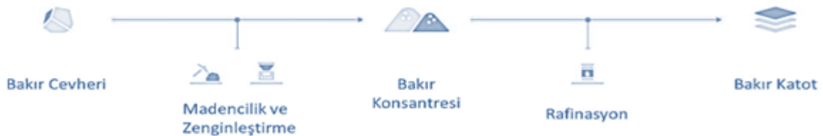
Şekil 14. Bakır Katot için Beşikten Kapiya Üretim Süreci
