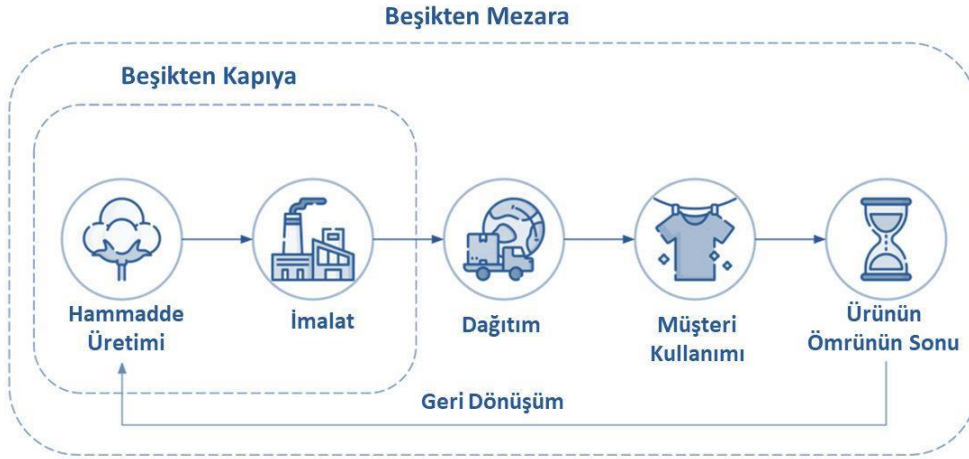
Şekil 12. ISO 14067'ye Göre Ürünün Karbon Ayak İzinin Sistem Sınırı
